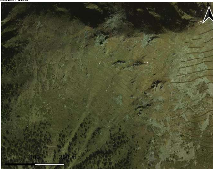
Foto 5.4 - Ortofoto P.A.T. anno 2015 della porzione medio – alta del sito valanghivo in esame in cui si possono osservare gli allineamenti delle opere di mitigazione del pericolo valanghivo.
